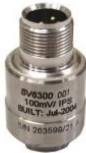
Велосиметр SV6300 имеет широкую полосу пропускания, что делает его идеальным для применения на множестве агрегатов и машин, от низкоскоростных вентиляторов до высокоскоростных турбин. Встроенный усилитель обеспечивает высокий уровень сигнала и низкое выходное сопротивление для передачи сигнала в удаленную систему контроля. SV6300 состоит термостабильного пьезоэлектрического датчика, усилителя и интегратора объединенных в одном корпусе из нержавеющей стали.
